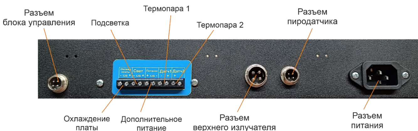
Рис. 3 Задняя панель блока нижнего подогрева
