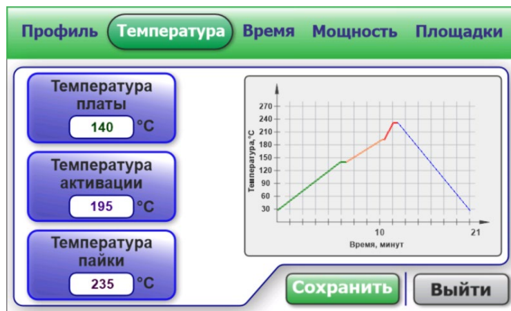
Рис. 8 Настройка температур термопрофиля
