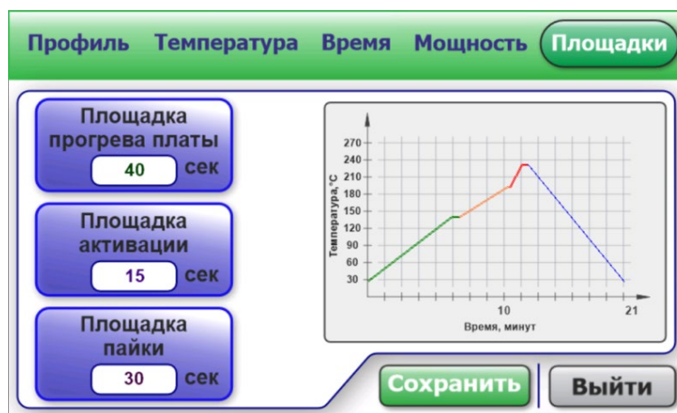
Рис. 11 Настройка площадок термопрофиля
