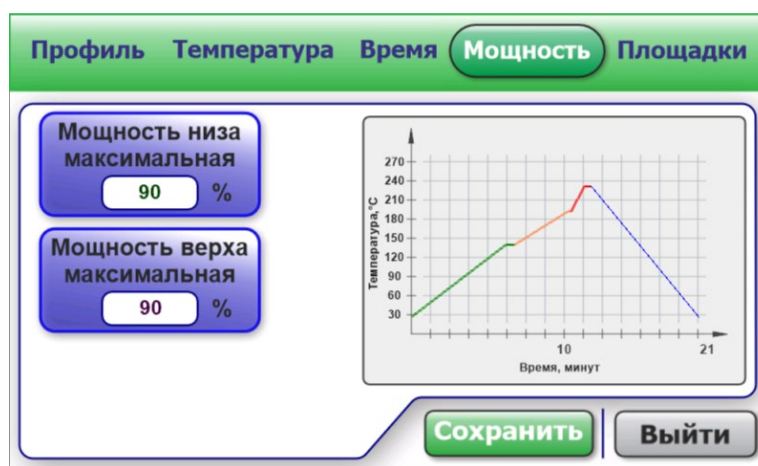
Рис. 10 Настройка мощностей излучателей
