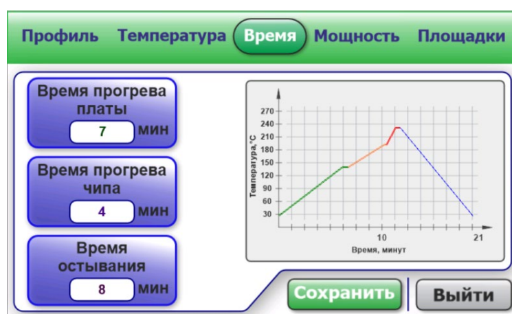
Рис. 9 Настройка времени термопрофиля
